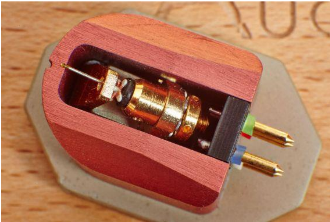
DER NADELTRÄGER BESTEHT AUS GEGLÜHTEM INOX-STAHL
